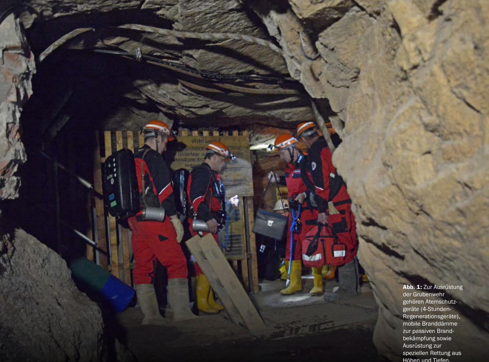
**Abb. 1:** Zur Ausrüstung der Grubenwehr gehören Atemschutzgeräte (4-Stunden-Regenerationsgeräte), mobile Branddämme zur passiven Brandbekämpfung sowie Ausrüstung zur speziellen Rettung aus Höhen und Tiefen.
